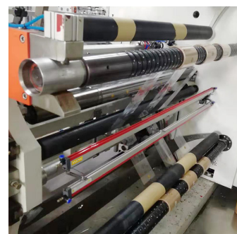
Imagen. Detalle de la barra EU136A en una cortadora
