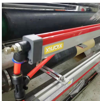
Imagen. Detalle de la barra EU136A en una cortadora
