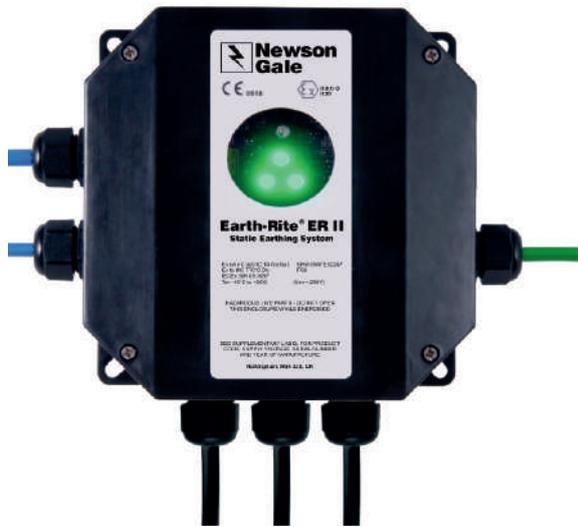
Este sistema resistivo se utiliza para poner tanto agitadores, bidones y/o camiones a tierra. Permite verificar que la conexión de la pinza es correcta, inferior o igual a 10 Ohms, entonces los LED's verdes del sistema se encienden y activan los procesos que se han enclavado en los dos contactos libres de potencia.
