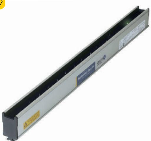
Dispositivo neutralizador de la electricidad estática, compacto y de alta eficacia, para ambientes con riesgo de explosión. El cable de conexión estándar dispone de un cable adicional para contacto de encendido/apagado remoto y una señal indicadora de AT OK. La barra Performax Easy Ex tiene los extremos ligeramente doblados y cumple con la categoría de protección IP66, lo que facilita la limpieza. Esta barra tiene una fuente de alimentación de alta tensión integrada.
