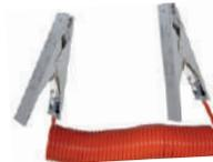
Cable espiral con pinza 021-VESX90 en cada extremo para conexiones equipotenciales entre un camión y un IBC u otra estructura metálica.
