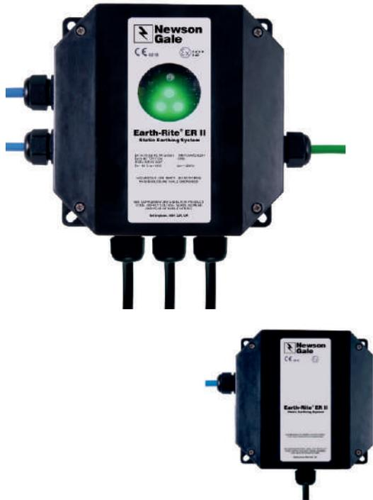
Este sistema resistivo se utiliza para poner tanto agitadores, bidones y/o camiones a tierra. Permite verificar que la conexión de la pinza es correcta, inferior o igual a 10 Ohms, entonces los LED's verdes del sistema se encienden y activan los procesos que se han enclavado en los dos contactos libres de potencia.
