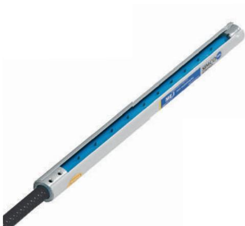
Las barras antielectrostáticas MEJ suelen utilizarse en máquinas de producción que permiten la ionización de corto alcance y en las que no hay piezas en movimiento que pudieran interferir en la ionización. La diferencia con la MEB es que es redonda, lo que hace que se pueda montar a través de los agujeros del bastiador de una máquina.
