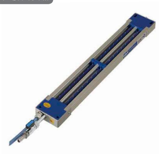
Barra ionizadora de gran potencia gracias a su diseño de construcción abierta que comporta la creación de un flujo de aire que permite un alcance de hasta 1.500 mm, asistidos por el tubo de aire comprimido que incorpora, juntamente con el diseño geométrico de los emisores.
