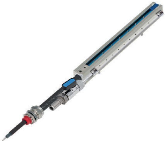
Barra adecuada para maquinaria industrial donde es necesaria una ionización de largo alcance, hay elementos metálicos que interfieran la ionización o bien se precisa limpieza. Cada emisor individual de esta barra rectangular está acoplado capacitivamente a la alta tensión. De esta forma no se percibe el calambre al tocar los emisores.
