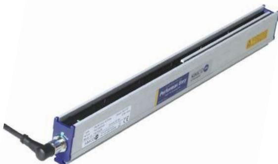
El robusto sistema de neutralización de electricidad estática Performax IQ Easy Speed, dotado de un perfil reforzado, ofrece una resistencia excelente a la deflexión para reducir los daños provocados por la flexión (accidental). La Performax IQ Easy Speed tiene una fuente de alimentación de alta tensión integrada y tan solo necesita una entrada de baja tensión de 24 V CC.
