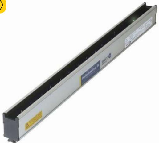
Dispositivo neutralizador de la electricidad estática, compacto y de alta eficacia, para ambientes con riesgo de explosión. El cable de conexión estándar dispone de un cable adicional para contacto de encendido/apagado remoto y una señal indicadora de AT OK. La barra Performax Easy Ex tiene los extremos ligeramente doblados y cumple con la categoría de protección IP66, lo que facilita la limpieza.
