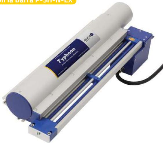
La cortina de aire está hecha de aluminio extruido y tiene ranuras de montaje incorporadas. Este diseño proporciona un caudal de aire preciso a lo ancho de toda la cortina de aire. El aire se presuriza en el tubo de la cortina de aire y genera iones positivos y negativos que se soplan contra la superficie por medio de la cortina de aire. A continuación, se produce un intercambio de electrones que neutraliza la superficie y elimina las impurezas.
