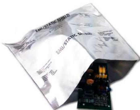
Bolsa para ser sellada al vacío, para evitar la condensación en componentes, que luego pueda comportar el indeseable fenómeno del "pop corning", debido al diferencial térmico en el proceso de soldadura.
