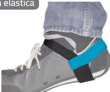
No marca el calzado y permite ajustarse fácilmente a todo tipo de zapato aunque sea deportivo flexionando al andar, lo que además proporciona mayor comodidad. Cierre de velcro. Goma de alta resistencia que ofrece una completa y rápida disipación electrostática. Incorpora una resistencia de seguridad de valor nominal 1Mohmio. La tira conductiva no se descompone. Tiempo de descarga <0,01s. Cumple EN 61340-5.1.
