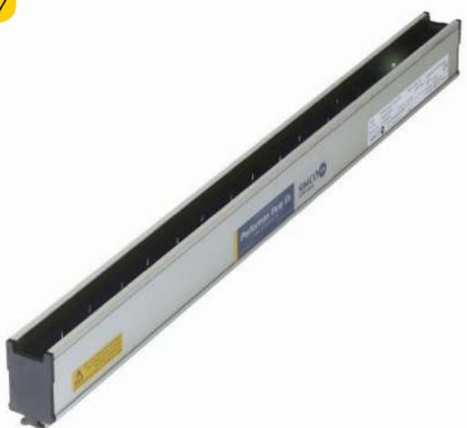
Dispositivo neutralizador de la electricidad estática, compacto y de alta eficacia, para ambientes con riesgo de explosión. El cable de conexión estándar dispone de un cable adicional para contacto de encendido/apagado remoto y una señal indicadora de AT OK. La barra Performax Easy Ex tiene los extremos ligeramente doblados y cumple con la categoría de protección IP66, lo que facilita la limpieza. Esta barra tiene una fuente de alimentación de alta tensión integrada.
