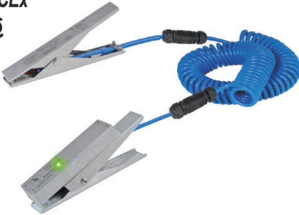
Versión de la pinza autochequeo adecuada para trasvases de camión a IBC. La conexión al camión es incierta, motivo por el que es necesario verificarla, lo cual hace de forma permanente, comprobando que la resistencia camión-IBC es inferior a 10 Ohmios.
