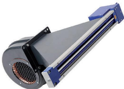
El soplador de aire ionizado HP-N-Ex está formado por un motor y un ventilador. El aire ambiente entra por un lado y se sopla a lo largo de una barra antielectrostática. La anchura de ionización efectiva son 500 mm. El soplador ionizador está homologado para el uso en determinados emplazamientos con riesgo de explosión. La unidad de alimentación está integrada en la barra antielectrostática.
