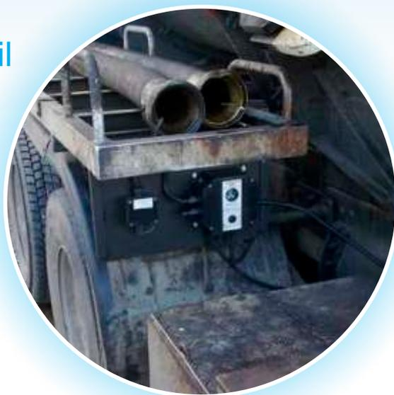
El sistema de puesta a tierra estática Earth-Rite MGV puede montarse en camiones de vacío y camiones cisterna.
